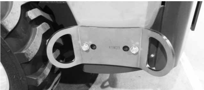
Soporte de amarre A418623 instalado en el lateral del chasis posterior. Para la instalación lateral, se necesitan dos soportes.
