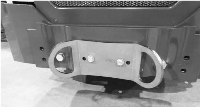
Soporte de amarre A418623 instalado en el parachoques o contrapeso traseros
